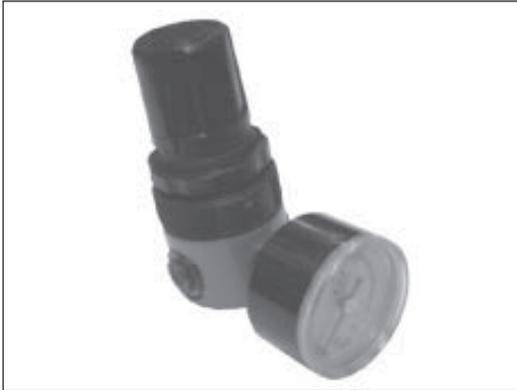
Reguladora de Presión Neumática. Conexión: 1/8" y 1/4" BSP. Cuerpo de aluminio, volante y campana inyectados en plástico, diferencial de presión: 1 bar, manómetro Ø40mm conexión 1/8" BSP. Presión de trabajo: 0 a 10 bar. Temperatura de trabajo: 0 a 50°C. Fluido: aire comprimido filtrado. Posición de montaje: indistinta. Opcional: escuadra para fijación.
